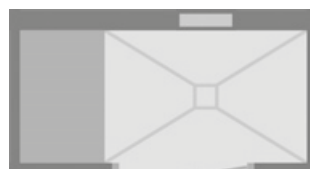
CAB-R 1780/950 R.LG * Tür DIN rechts / Sitzbank links der Tür / Installationswand gegenüber der Tür
