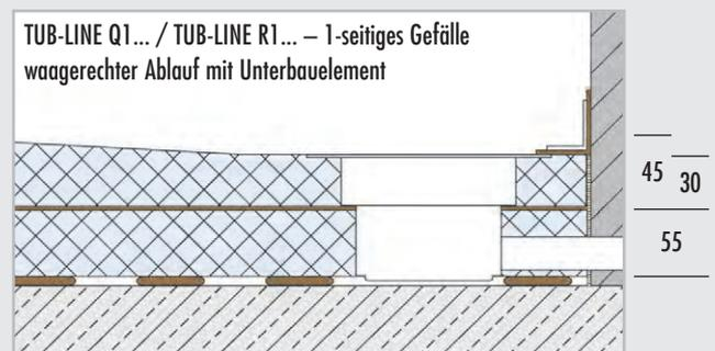
\* Beim Einbau des senkrechten Ablaufs ohne Unterbauelement verringert sich die Gesamthöhe um die Höhe des Unterbauelements (= 55 mm).
