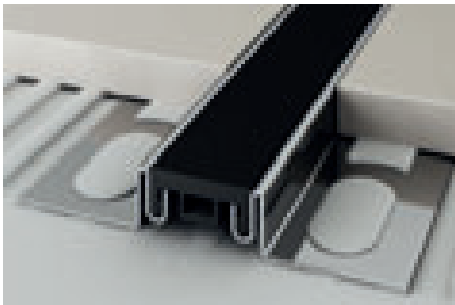
NPI/10 Edelstahl AISI 304 - DIN 1.4301+ Gummieinlage, Schwarz
